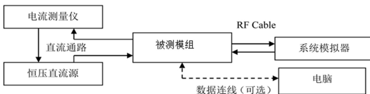
图 D.1 功耗测试系统示意图
