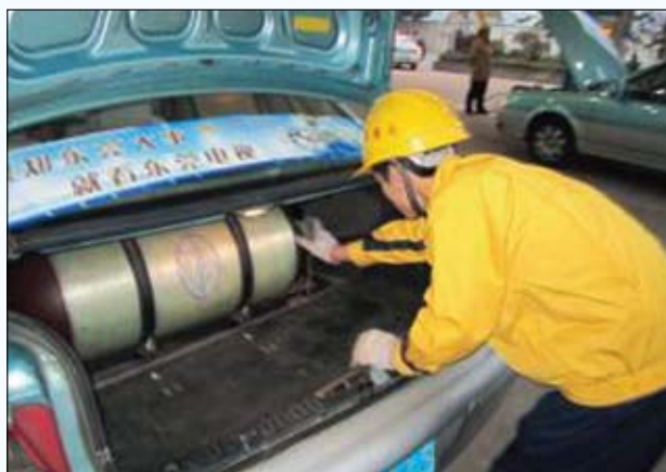
图8 加气操作工正在扫描主标签以启动加气机加气
