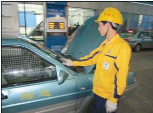
图10 加气操作工正在扫描副标签以启动加气机加气
