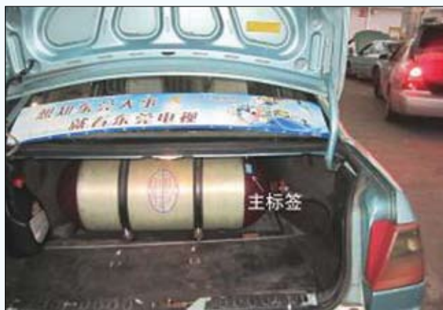
图7 粘贴在钢瓶上的主标签
