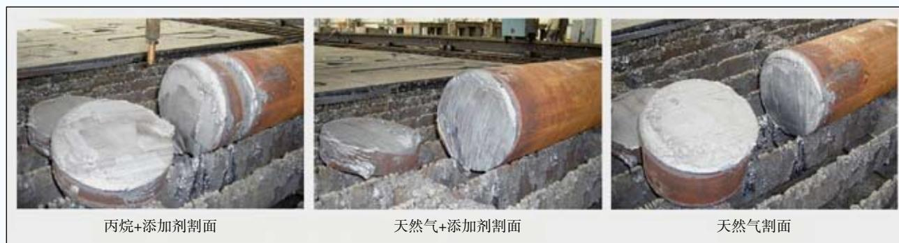
图2 切割对比实验割面效果
