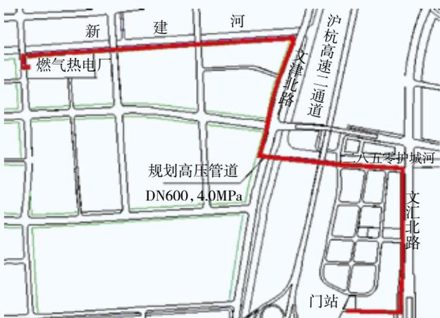
图1 电厂供气管线示意
