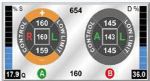
图4 压力遥调SCADA界面图
