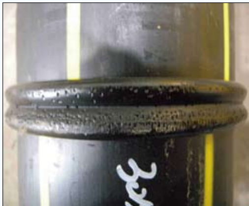
图5 间距3cm烘烤20min管材焊口
