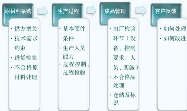
图3 燃气产品认证全过程控制示意
