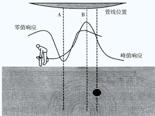
图17 移动1.5倍间距修正管道真实位置示意图
