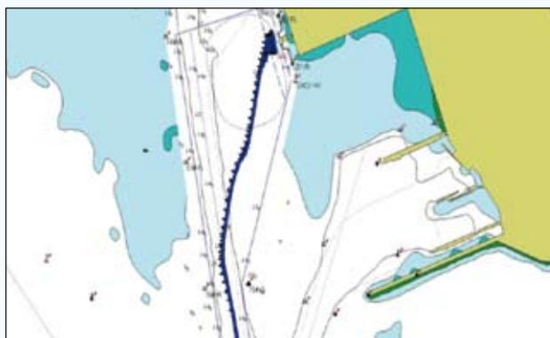
图5 LNG船舶在操船模拟器上的靠泊运行轨迹
