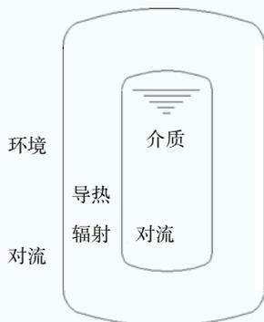
图1 LNG储罐的传热模型图
