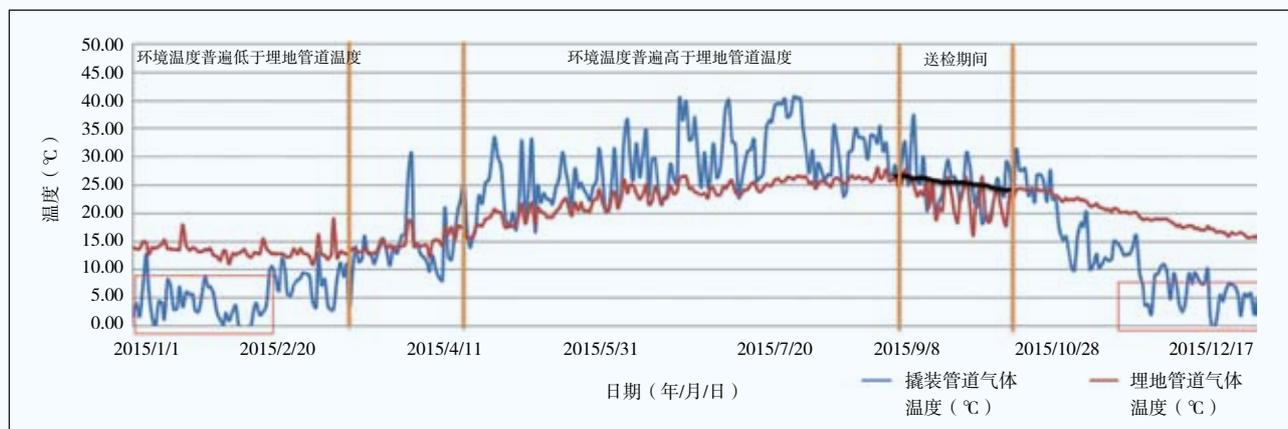
图1 2015年上午时段撬装管道气体与埋地管道气体温度变化趋势图
