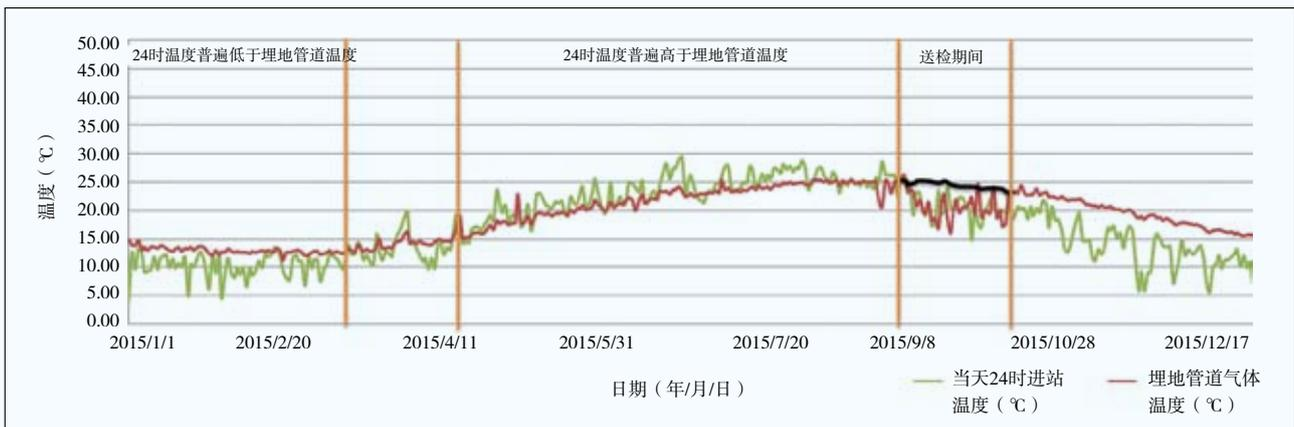
图3 2015年每日24时段撬装管道气体与埋地管道气体温度对比图
