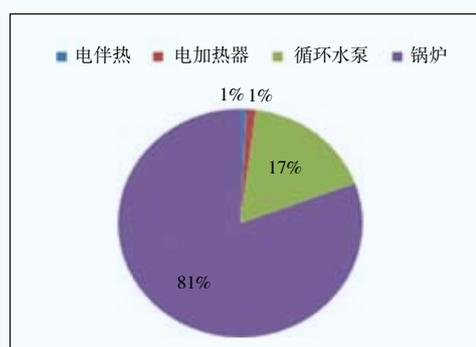
图5 换热设备能耗比例图
