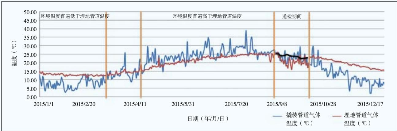
图2 2015年下午时段撬装管道气体与埋地管道气体温度变化趋势图
