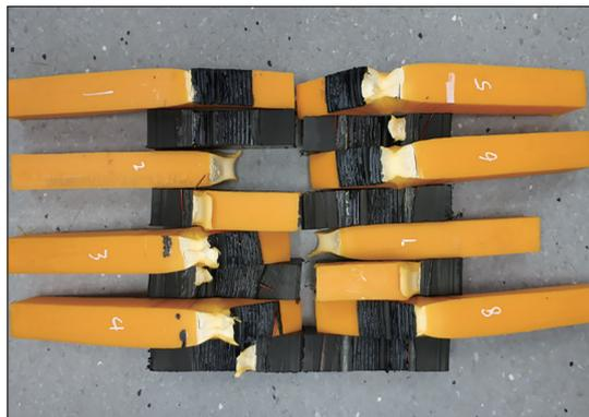
(b) 电熔接头试样拉伸后
