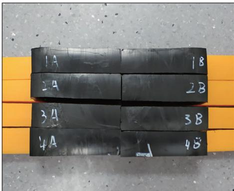
(a) 电熔接头试样拉伸前
